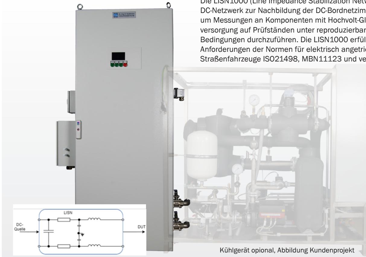
Die LISN1000 (Line Impedance Stabilization Network) ist ein DC-Netzwerk zur Nachbildung der DC-Bordnetzimpedanz, um Messungen an Komponenten mit Hochvolt-Gleichstromversorgung auf Prüfständen unter reproduzierbaren Bedingungen durchzuführen. Die LISN1000 erfüllt die Anforderungen der Normen für elektrisch angetriebene Straßenfahrzeuge ISO21498, MBN11123 und vergleichbare.
