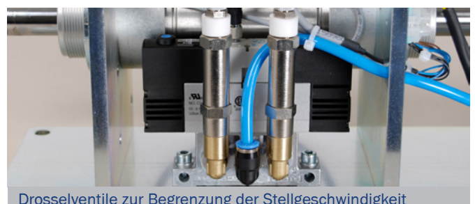
Drosselventile zur Begrenzung der Stellgeschwindigkeit
