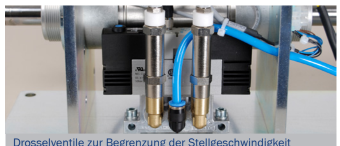
Drosselventile zur Begrenzung der Stellgeschwindigkeit
