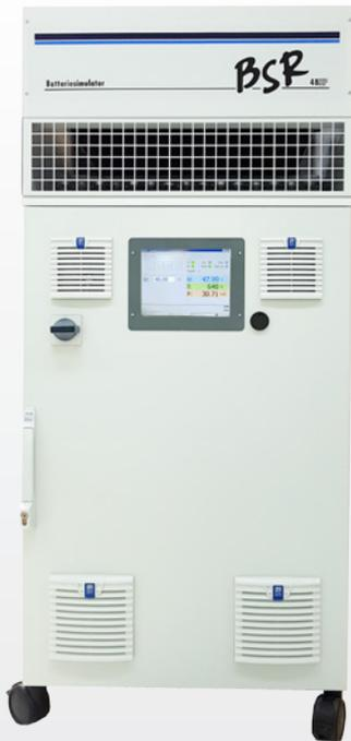
Der Batteriesimulator ist eine Gleichspannungsquelle/-senke, welche geeignet ist, Batteriesysteme der Nennspannung 12 VDC bis 48 VDC in ihrem statischen und dynamischen Verhalten nachzubilden und die Originalbatterie in ortsfesten Prüfanlagen zu ersetzen. Die Vorgabe definierter Arbeitspunkte und Parameter ermöglicht aussagekräftige und reproduzierbare Tests von Komponenten für das 48 V-Bordnetz.
